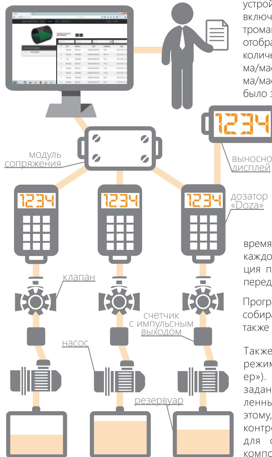
устройство начинаяет пролив посредством включения насоса или воздействия на электромагнитный клапан при этом, на дисплее отображается постоянно изменяющееся количество литров (или других единиц объема/массы). При достижении значения объема/массы равному тому, которое было задано для пролива, устройство отключает насос (или клапан), тем самым завершая операцию пролива и запоминает её.
